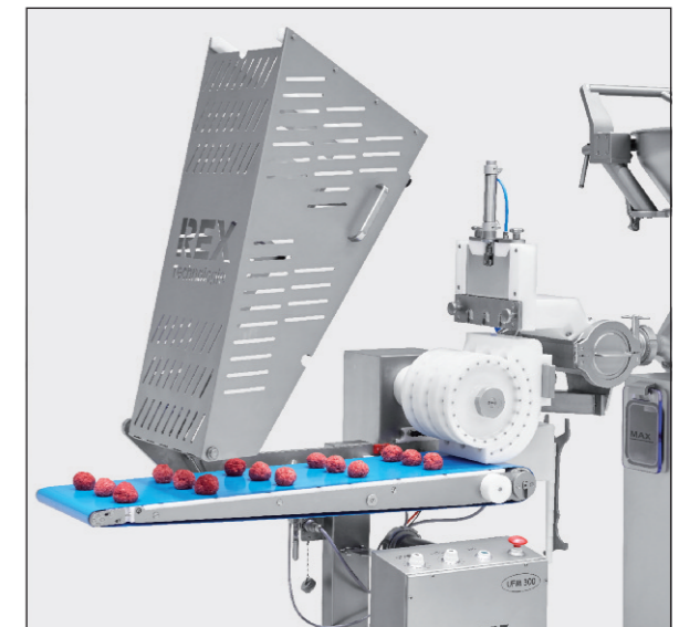
Leistungstark durch mehrreihige Formrollen
